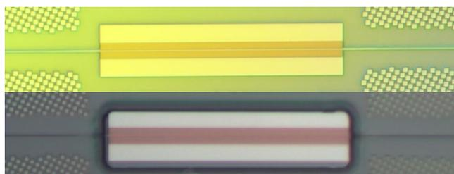
図 4 : シリカクラッド (上図) とエアクラッド (下図) のフォトニック結晶の顕微鏡画像。
